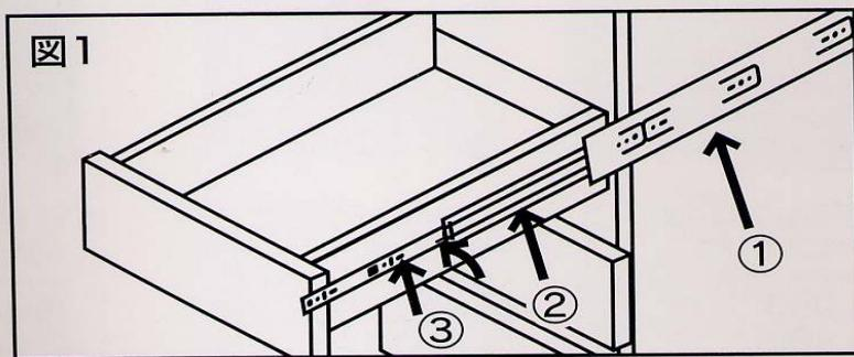
※ただし、途中でガクッという音がして止まった場合、ベアリングケースの溝に入っていない事がありますので、無理に差し込むとベアリングが取れて壊れますので再度同じ手順で繰り返して下さい。
